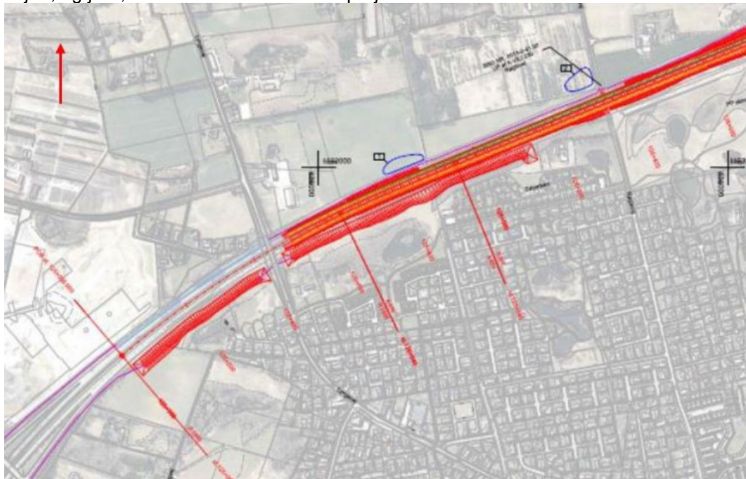
Figur 1: Placering af støjvolden umiddelbart øst for Hillerød Motorvejen - se rød markering.
