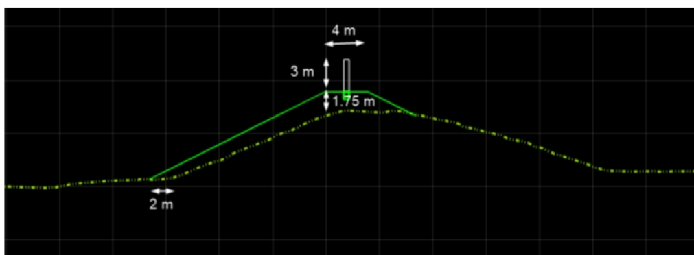
Figur 5: Udvidelse nord for Lyngvej. Den eksisterende støjvold udvides med mellem 5,5 m og 12 m i bredden. Herunder ses to eksempler på tværsnit gennem volden, der viser, hvor der indbygges jord.
